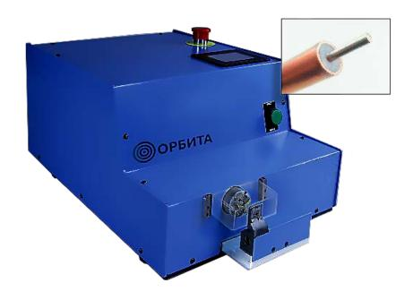
Настольная установка Orbita CO32H производит снятие изоляции с жесткого и полужёсткого кабеля сразу после обрезки в размер. Прецизионный двухосевой механизм зачистки, оснащенный шаговыми двигателями, обеспечивает ровную прямоугольную кромку медной трубки и исключает повреждение внутреннего проводника. После зачистки с обеих сторон заготовка готова к установке соединителей.
