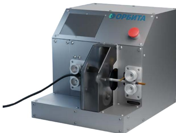
Настольный лентообмотчик предназначен для спиральной и точечной обмотки кабелей и жгутов изоляционными лентами с клеевым слоем и без него. Тип установки – настольная. Запуск работы/останов машины осуществляется с помощью педали. Плотность перекрытия регулируется роликами подачи кабеля. Для ввода параметров и считывания текущего состояния предусмотрена сенсорная панель, установленная на крышке машины.
